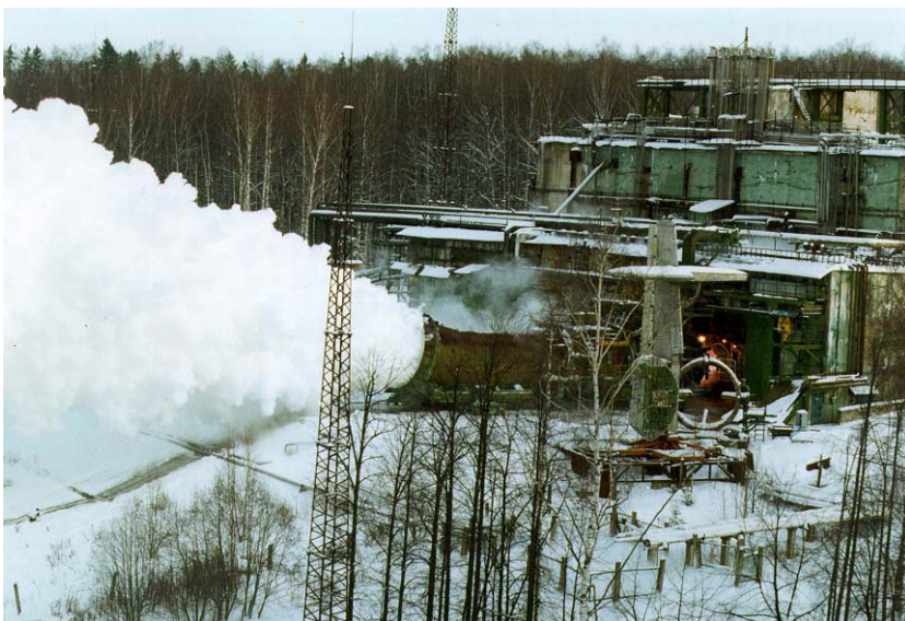
Рис. 2.19. Испытание ЖРД РД0120 на стенде с устройством глушения шума в газоотводной трубе с рассекателями струи
