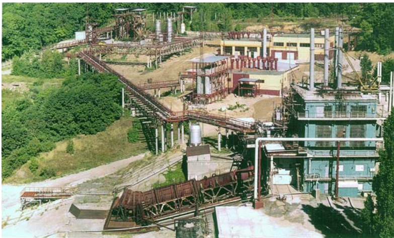
Рис. 2.2. Наклонный стенд для испытания ЖРД на испытательном комплексе КБХА (стенд показан на переднем плане)
