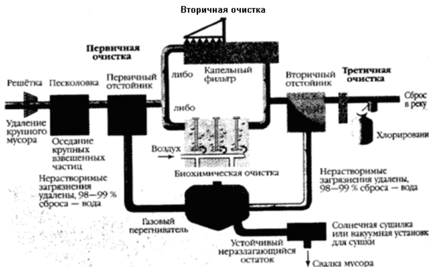
Рис. 2.3. Принципиальная схема промышленной системы очистки сточных вод
