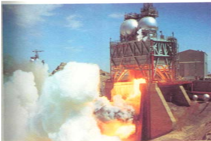
Рис. 2.38. Испытательный стенд для испытания ЖРД F-1
